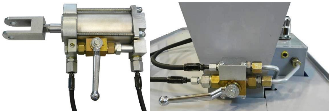
Рис. 51. Положение кранов при обратном ходе гидроцилиндра
