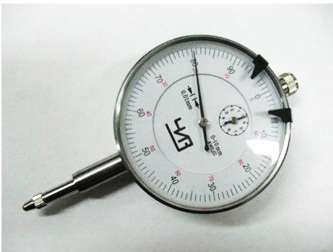
Рис. 55. Стрелочный индикатор: а – внешний вид; б – схема устройства
