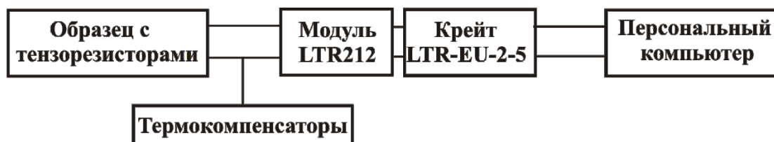
Рис. 59. Блок-схема сбора и обработки измерительной информации при выполнении лабораторных работ по курсу «Сопротивление материалов»
