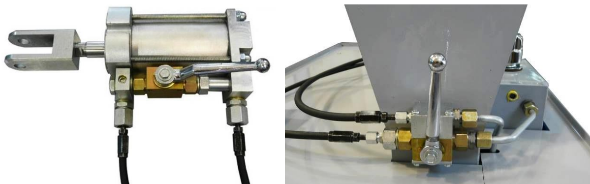
Рис. 50. Положение кранов при прямом ходе гидроцилиндра
