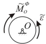
3) при вращательном движении около главной и центральной оси инерции  $\{d\vec{\Phi}\}_C \sim \vec{M}_C^\Phi = -I_{z_C} \vec{\epsilon}$ ;
