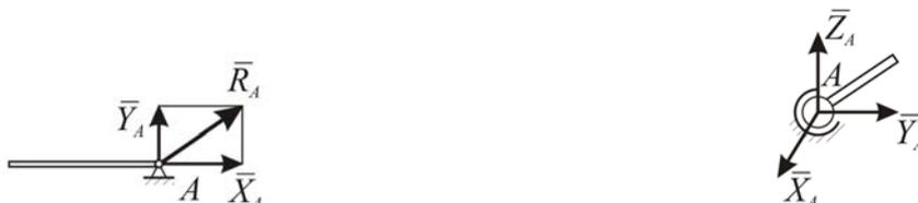
Неподвижный цилиндрический шарнир
