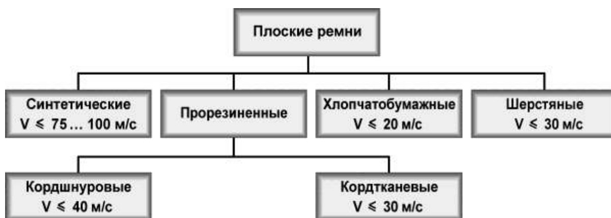
Рис. 1.5. Материалы плоских ремней
