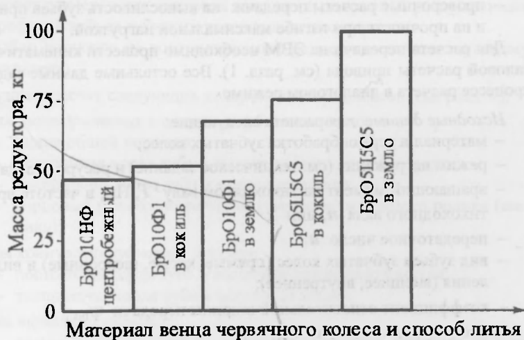
Рис. 10.2. Зависимость массы червячного редуктора от материала венца червячного колеса
