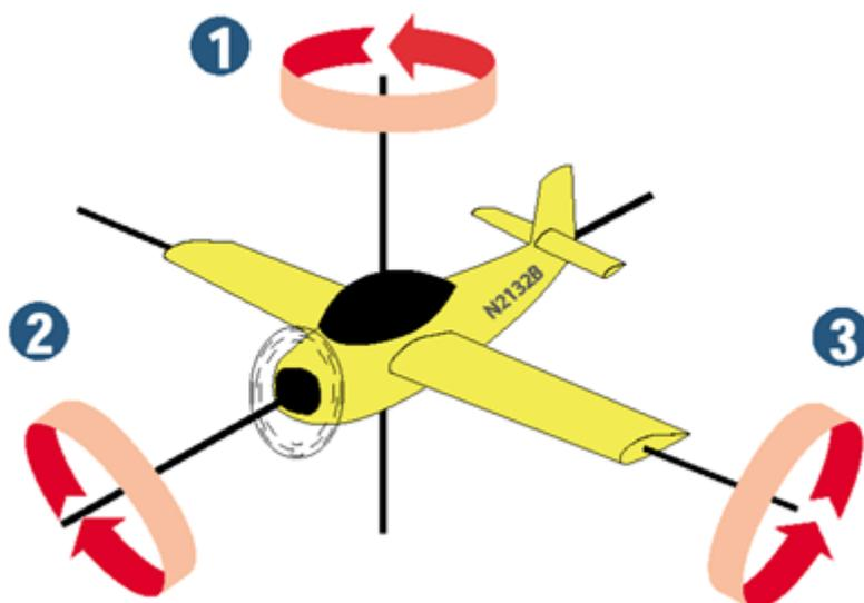
Рис.3.1.7. Три оси самолета
