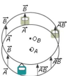
Mouvement d'une nacelle d'une grande roue.
