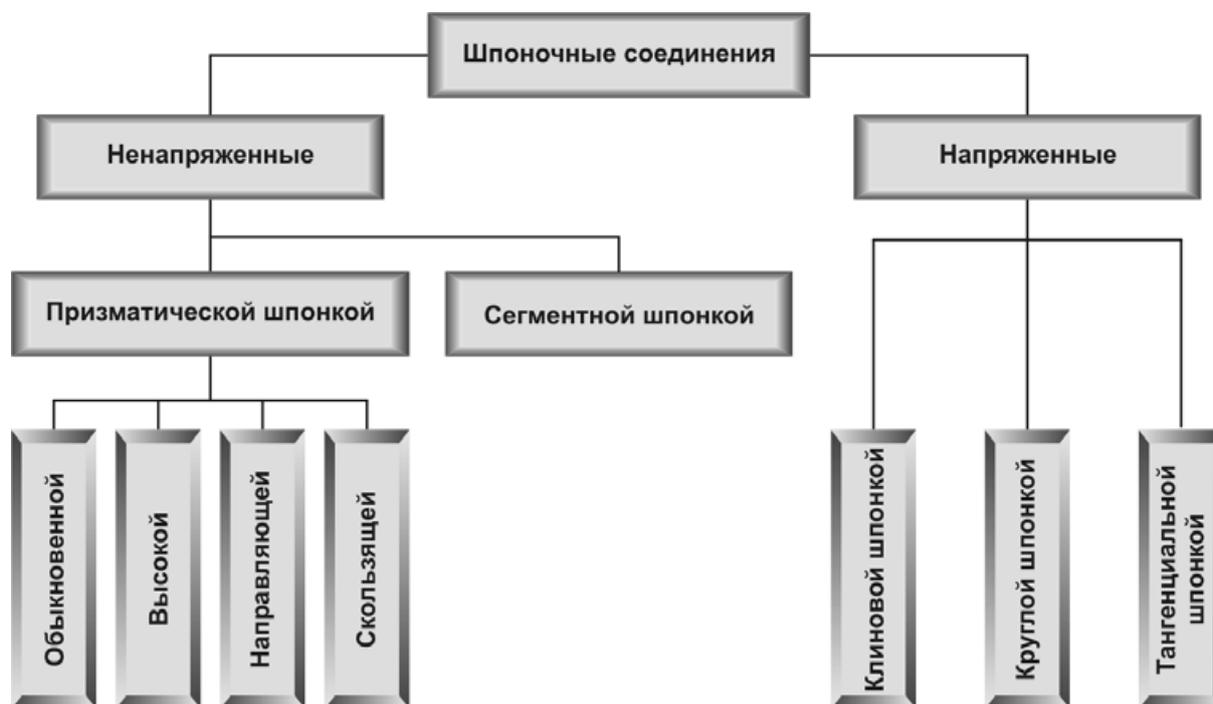
**Рис. 6.2. Классификация шпоночных соединений**
