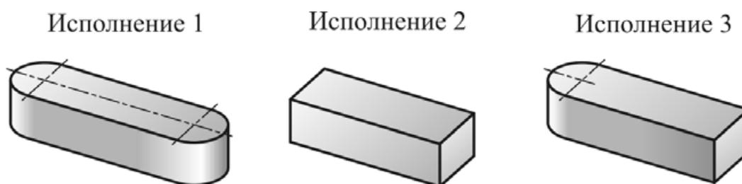
**Рис. 6.3. Конструкции призматических шпонок**
