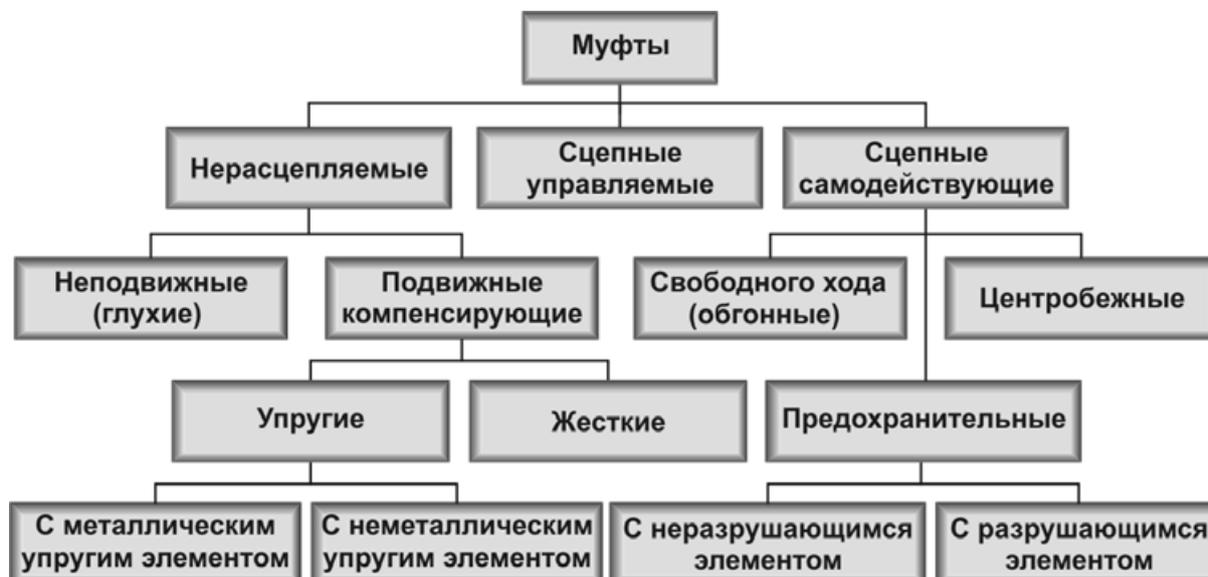
Рис. 5.1. Классификация механических муфт
