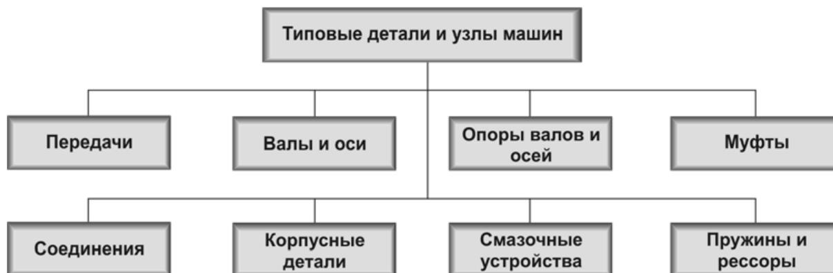
**Рис. 1.1. Классификация деталей и узлов машин**
