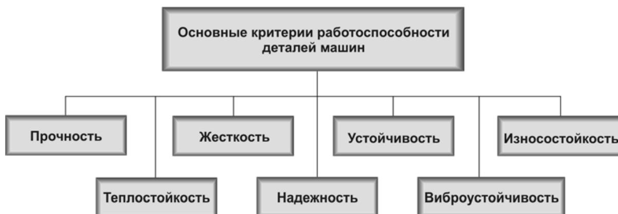
**Рис. 1.2. Основные критерии работоспособности деталей машин**
