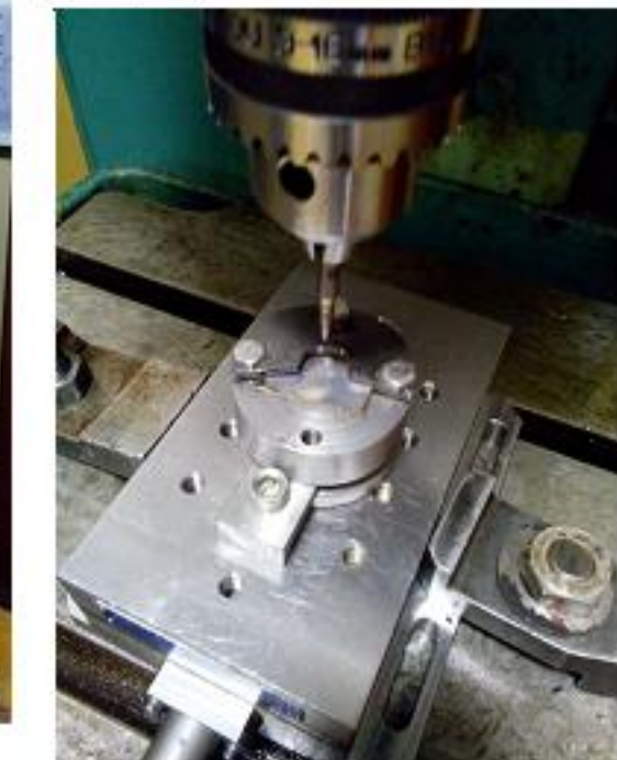
Динамометр модели 9257В фирмы Kistler со встроенным усилителем типа 5070A01110
